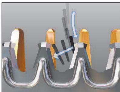
La lame d'effilage en X (lame mobile) capture le cheveu au plus près. Résultat : une coupe très précise et plus uniforme.
