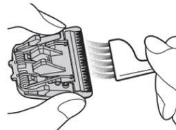
3. Brossez toute trace de cheveux de la lame fixe et de la lame mobile, tout en appuyant sur le levier de nettoyage (a) pour soulever celle-ci.
