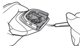
2. Retirez les poils sur le bord de lame.
