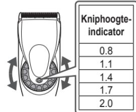
Gebruik een opzetstuk voor een kniplengte van 3 mm of meer.
