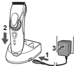
**2 Placez l'appareil sur le socle de recharge.**
